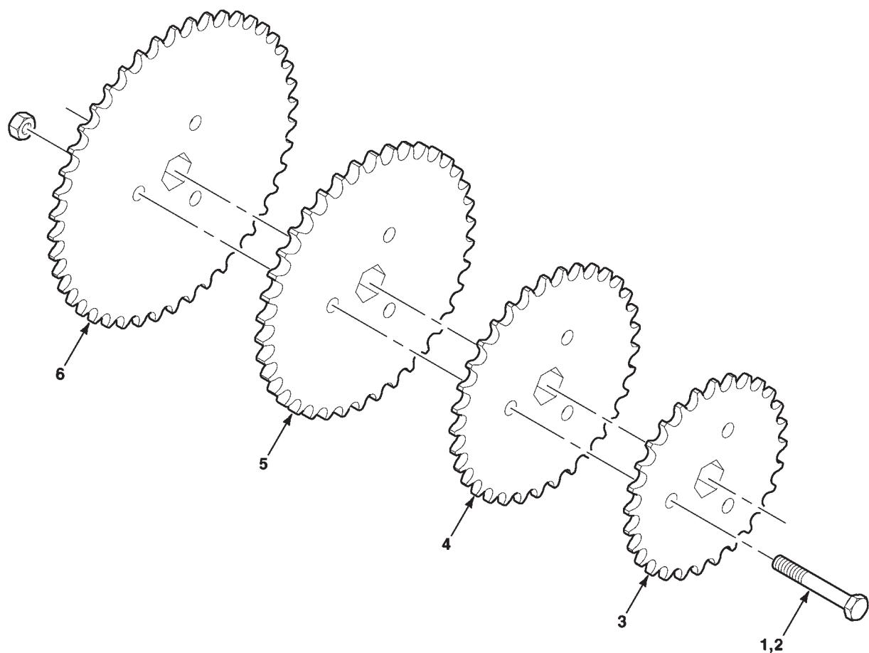
TRANSMISSION SPROCKET ASSEMBLY
