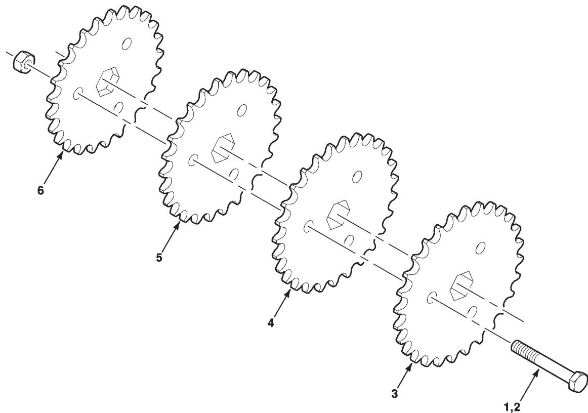
TRANSMISSION SPROCKET ASSEMBLY
